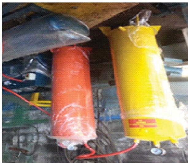
Gambar 3 Penyaring dan Pemurni Biogas
