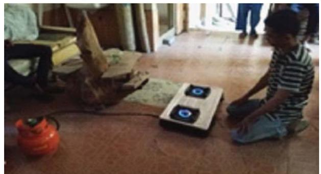
Gambar 8 Uji Coba Tabung Isian Biogas Pada Kompor
