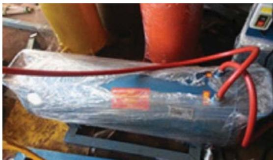
Gambar 5 Tabung Penampung Biogas Bertekanan (Header)
